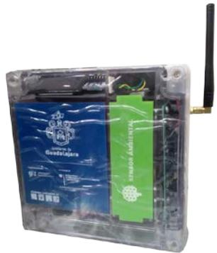
Desarrollado bajo la filosofía (**Hazlo por ti mismo, por sus siglas en inglés**), el sensor ambiental utiliza un Arduino como microcontrolador para procesar datos de los sensores de **humedad, temperatura, ruido, radiación y partículas de materia**. El compuesto incluye un dispositivo **GPS** y utilizamos la tarjeta de **SigFox**, tecnología diseñada para transmisión de datos en dispositivos orientados al **Internet de las Cosas**.
